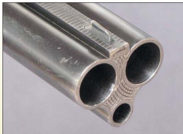
Илл. 7. Серийный тройник фирмы E. Schmidt & Habermann 1935 года под патроны 16-65/16-65/8x57IR, разработанный на базе её предыдущих моделей 22 и 26
