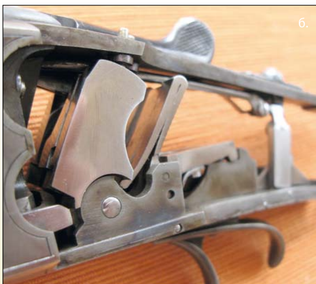
Илл. 10. Независимые ударные механизмы с верхними штифтовыми указателями активации установлены параллельно друг другу на горизонтальном основании (нижней личине) и включают нижние шептала, двупёрые боевые пружины, действующие непосредственно на курки. Система отдельного замка на нижнем основании разработана в Германии фирмой J. P. Sauer&Sohn Suhl (DRP № 78 411 от 3 ноября 1893 г.) и позже, уже в 1930-е годы, получила название «блиц» (Blitz – «молния»).
