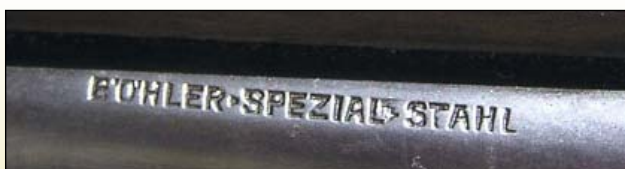
Илл. 16. Маркировка специальной (универсальной, термообработанной) стали компании «Братья Бёлер»
