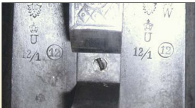
Илл. 13 и 14. Маркировка калибра и диаметров каналов стволов для преимущественного использования патронов, снаряженных в металлические гильзы
