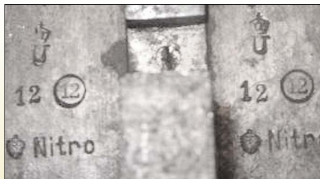
Илл. 13 и 14. Маркировка калибра и диаметров каналов стволов для преимущественного использования патронов, снаряженных в металлические гильзы
