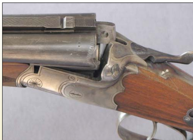
Илл. 7. Серийный тройник фирмы E. Schmidt & Habermann 1935 года под патроны 16-65/16-65/8x57IR, разработанный на базе её предыдущих моделей 22 и 26
