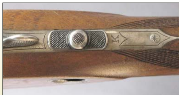
Илл. 12. Кнопка фиксируемого предохранителя для нижнего нарезного ствола, совмещённая с переводчиком последовательности выстрелов
